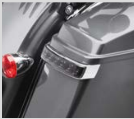
E. ELECTRA GLO LED-BREMS-/BLINK-RÜCKLEUCHTEN-KIT FÜR SATTELTASCHEN – CHROMGEHÄUSE / GETÖNTES GLAS
